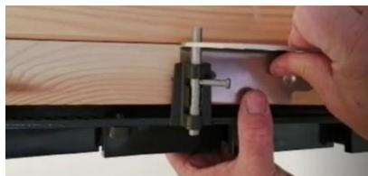
5. Wenn die Sets geschlossen sind, setzen Sie das Schloss so auf die Kante des Pfostens, dass das Schloss in das obere Loch passt.
