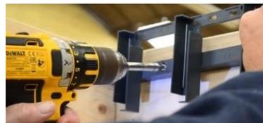
3. Pr ufen Sie, ob die Verbindungsschienen nach nach oben gerichtet sind.
