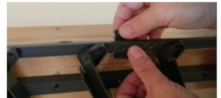
4. Vergewissern Sie sich, dass die Verbindungsschienen aus Aluminium und PVC mit den Verriegelungsklammern verbunden sind.
