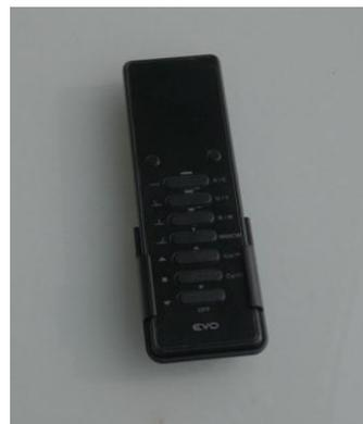
8. Nehmen Sie das System in Betrieb und prüfen Sie die Funktion mit der mitgelieferten Fernbedienung. Befestigen Sie die Fernbedienungshalterung an der Pergola.
