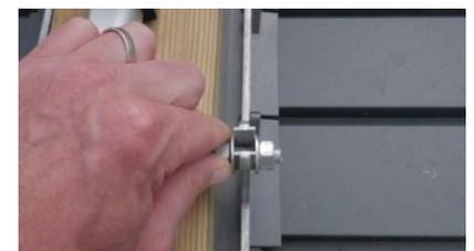
5. Schließen Sie die Muttern auf beiden Seiten mit einem 16-mm-Schlüssel. Die Lamelle muss immer in geschlossener Position sein.
